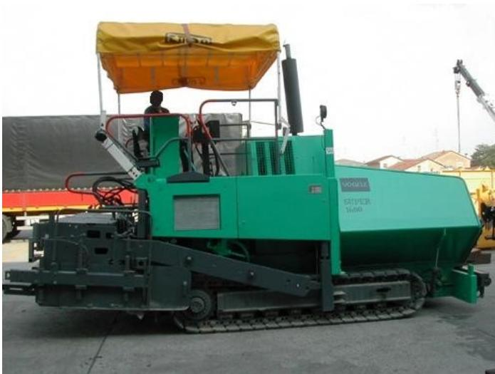
Gleichmäßige Verteilung durch Einsatz eines geeigneten Fertigers
