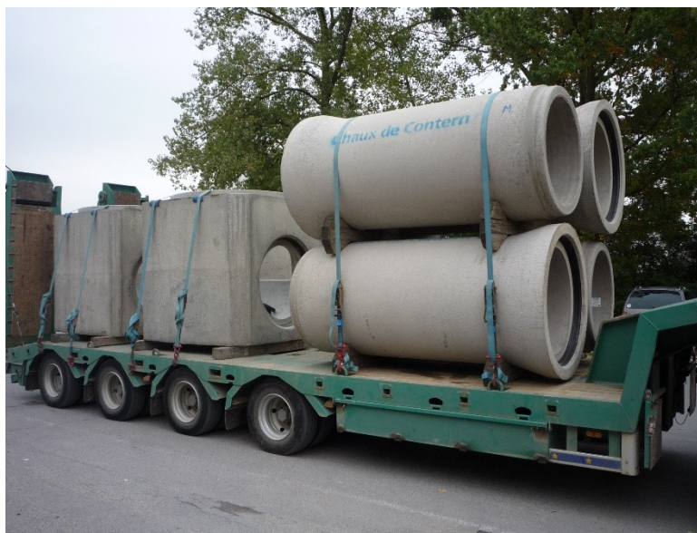
Camion chargé de tuyaux en béton armé
