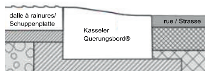
Système Kasseler Querungsbord® avec surface anti-glisement posé à niveau 0. Kasseler Querungsbord® mit Nullabsenkung und rutschhemmend genoppelter Oberfläche.
