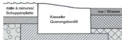
Système Kasseler Querungsbord® avec surface anti-glisserment posé à niveau 0.
