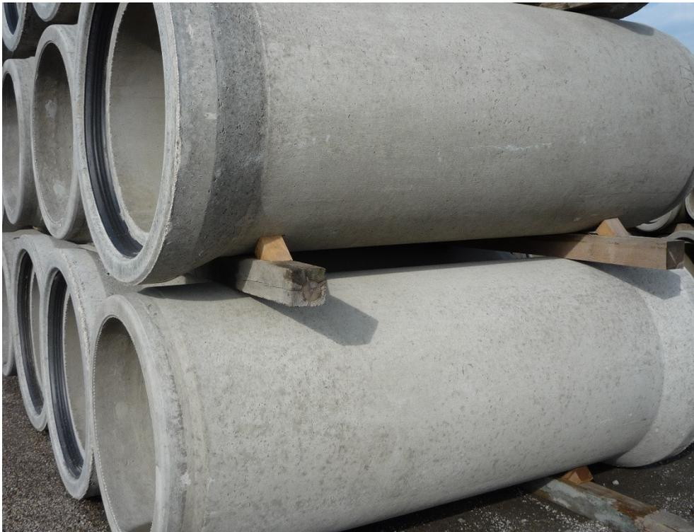
Ordnungsgemäß gelagerte Stahlbetonrohre auf der Baustelle
