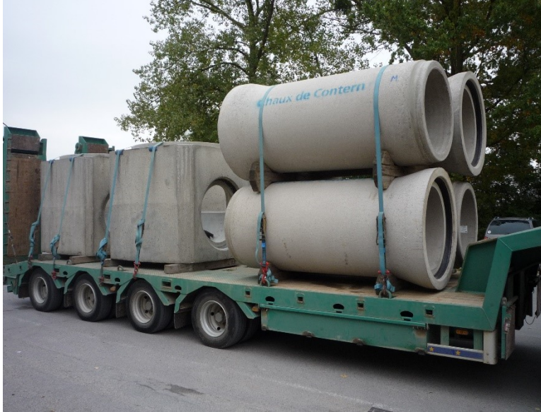
Camion chargé de tuyaux en béton armé
