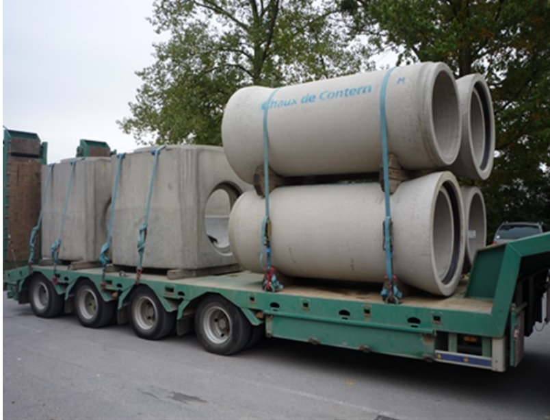
Éléments de regard bien sécurisés sur le camion
